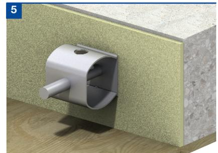
Empuje el pasador a través del relleno de la junta (si procede) hasta que esté perfectamente colocado en la vaina. Puede ser necesario golpear el pasador para superar el hoyo que sujeta a presión el pasador en la vaina e impide su desplazamiento cuando se vibra el hormigón.
