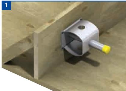
Clave la vaina al elemento de encofrado asegurando que la vaina quede orientado correctamente en la dirección de la carga. Compruebe que no se superan los valores mínimos de separación y distancia al borde. La etiqueta impide que entren residuos en la abertura de la vaina y no se debe quitar en esta etapa.
