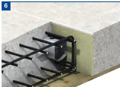
Fije la armadura local en posición alrededor del pasador junto con otra armadura cualquiera que sea necesaria, asegurando que se mantiene el recubrimiento correcto de la armadura. Vierta el hormigón para completar la instalación del conector para esfuerzo cortante.
