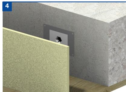
Coloque el relleno de junta compresible de la anchura adecuada, en el caso de aplicaciones en las que se espera que haya movimiento entre las dos secciones de hormigón.
